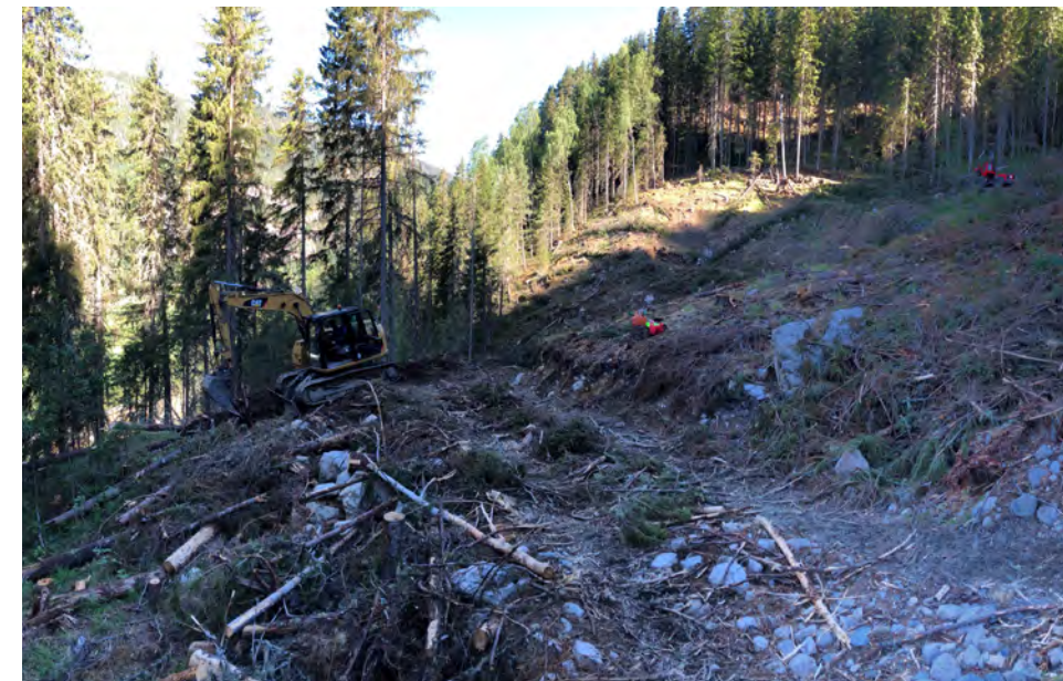
Figur 10. Avverkning i brant terräng med hjälp av en grävmaskin. Foto: Martin Bråthen, Skogkurs.
