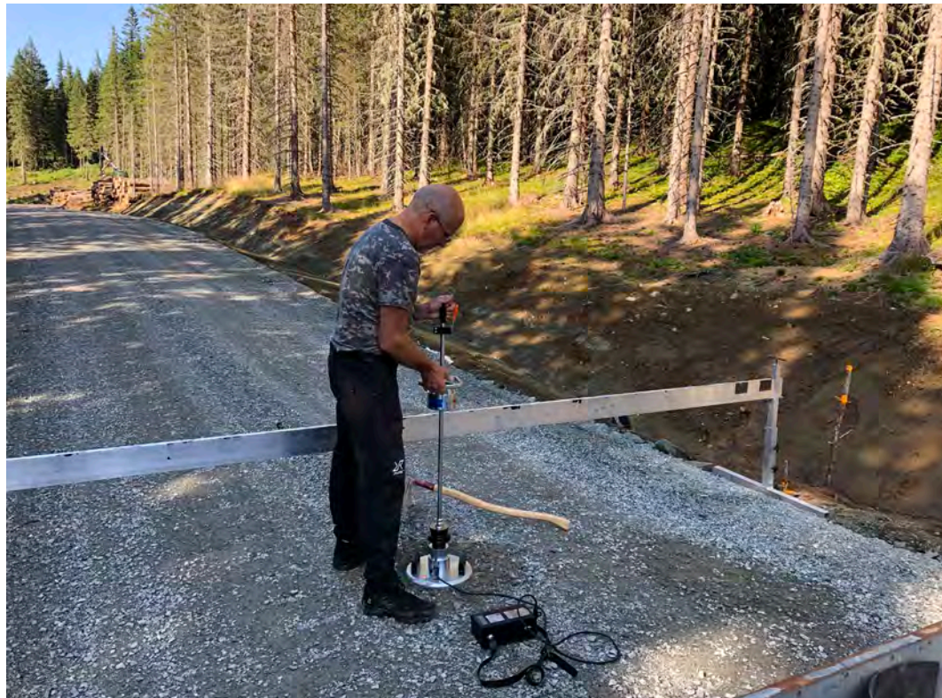
Bärighetsmätning utförd av vägplanerare Bjørn Arve Øvereng på en nybyggd väg. En gedigen och snyggt utformad väg. Bild: Martin Bråthen, Skogkurs.
