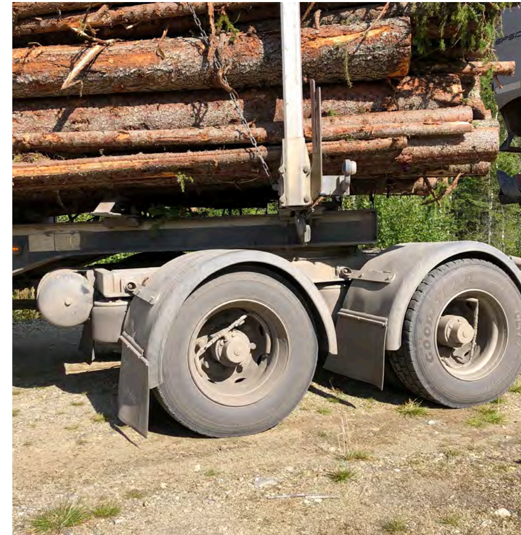
TPC - reglerar lufttrycket i däck. Lägre lufttryck ger en större yta på vägen vilket minskar marktrycket. Bild: Martin Bråthen, Skogkurs.
