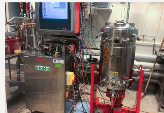
FIGUR 2. En 50-liters bioreaktor som fungerar mycket bra för odling av SCP.
