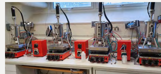
FIGUR 1. Ett bioreaktorsystem i stål med fyra reaktorer på 3 liter som användes för att odla celler. Tanken med dessa var att vi skulle odla kontinuerligt, men leverantören lyckades inte få det att fungera med vår SCP-organism.
