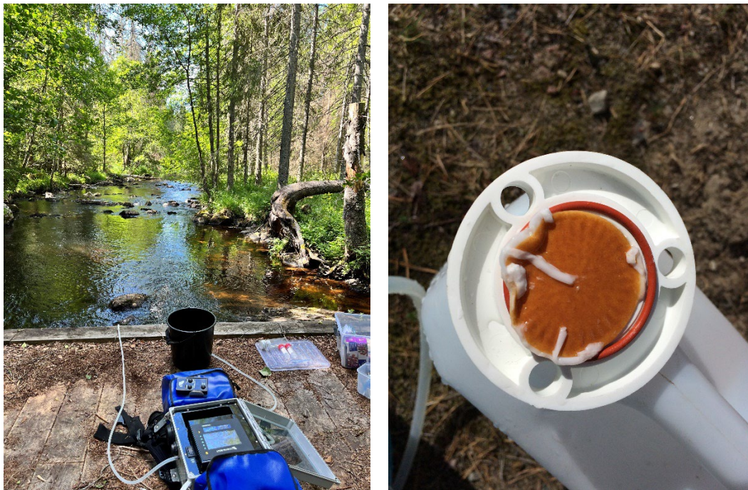
Figur 2. Det finns många olika typer av pumpar som kan användas för att filtrera vatten. Vänstra bilden visar rygsäckspumpen som är en av de pumpar som använts inom projektet. Bilden till höger visar glasfiberfiltret efter att vatten filtrerats genom filtret.
